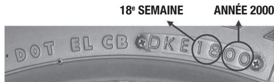
**Pneus fabriqués avant 2000 :** Les trois (3) derniers chiffres du numéro de série évoquent la semaine et l'année de production. Par exemple, un pneu dont le numéro de série se termine par les chiffres 329 a été fabriqué la 32<sup>e</sup> semaine de l'an 1999, mais peut aussi avoir été fabriqué en 1989. En cas de doute, consultez un professionnel qualifié dans l'entretien des pneus.
